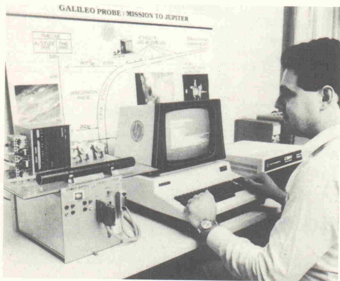
In der Technischen Universität Braunschweig werden zur Zeit umfangreiche Testreihen durchgeführt. Der Computer simuliert dabei Weltraumbedingungen. Links neben dem Rechner die Magnetantenne der Jupitersonde.
